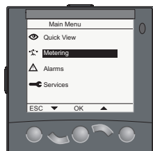
Дисплей щитового индикатора FDM121: перемещение по меню
