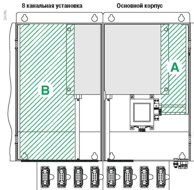
**A** : стандартный слот для оборудования передачи данных, базовый корпус.
