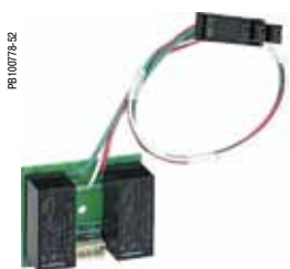
Контакты M2C: 2-контактное встроенное реле
