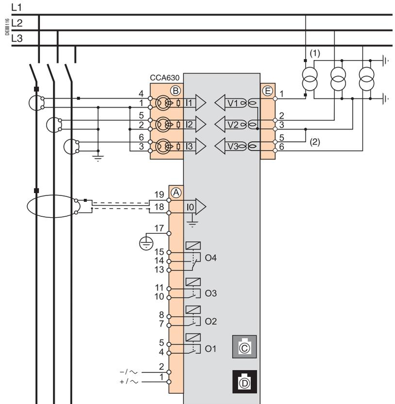
(1) Данная схема подключения позволяет рассчитывать напряжение нулевой последовательности.
